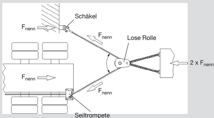
Verdoppelung der Zugkraft mit zweitem Festpunkt am Fahrgestell (doppelter Zug)
